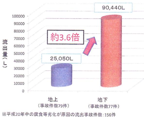
図3 危険物施設における腐食等劣化を原因とする流出事故の発生場所に係る流出量の比較（平成20年中（平成20年1月1日～12月31日））
